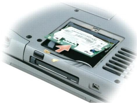
3. 如果尚未安装小型 PCI 卡，请转至步骤 4。如果要更换小型 PCI 卡，请取出现有的 PCI 卡：
