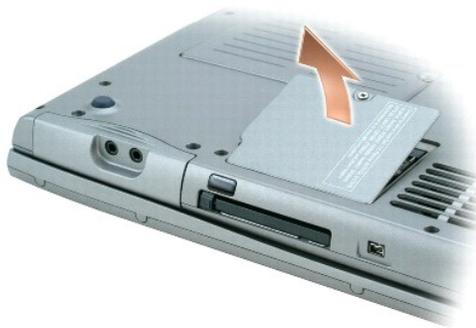
2. 将手指放在护盖下的凹口处并向上顶，将护盖滑开。
