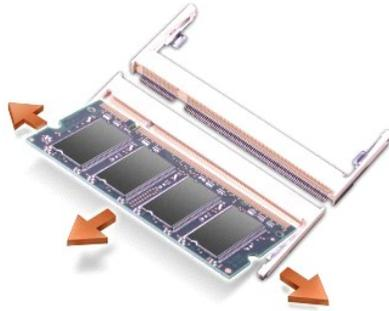
➡ **注意：**如果您需要在两个连接器中安装内存模块，请首先在标有“JDIM (DIMM)”的连接器中安装内存模块，然后在标有“JDIM2 (DIMM2)”的连接器中安装另一个模块。
